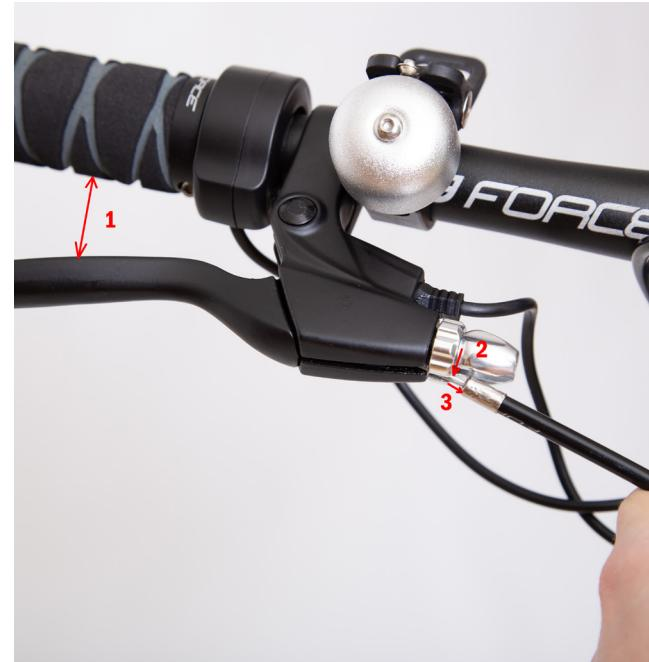
2. Opět stiskněte brzdovou páčku a zatáhněte za bowden brzdy tak, aby se posunulo co nejdále od stříbrné koncovky. Lanko můžete opřít o matku č.2 a několikrát zapumpovat pákou brzdy č.1, aby se stříbrná koncovka odsunula co nejdál č.3.
