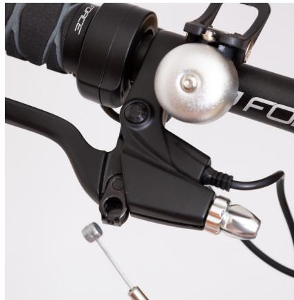
1. Stiskněte brzdovou páčku a vložte váleček do otvoru.
